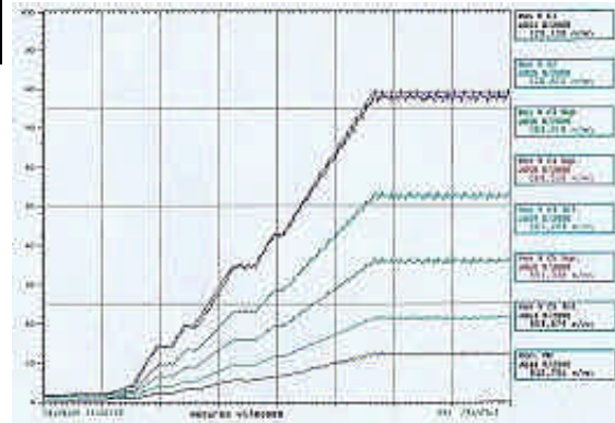
Exemple de sortie imprimante : vitesses référence et réelles du 5Cages de SOLLAC Basse-Indre
